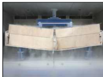
GTT Mark-III 시스템 2차 방벽 복합재의 실구조단위 거동 평가 및 강제 용접부 시험절차 정립
